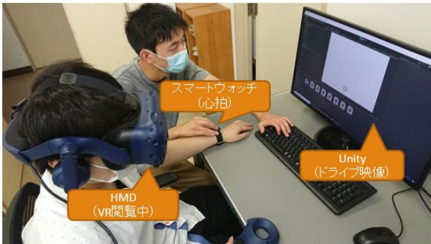
図 1 VR 型運転再現システムの構成
